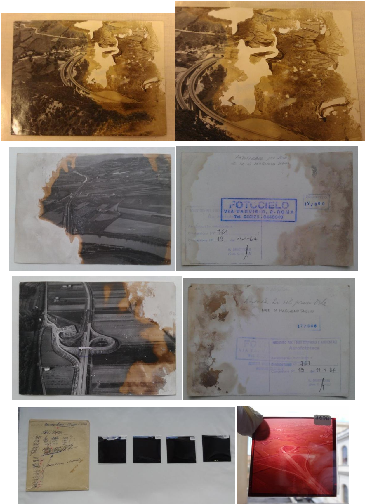
Figg. 38-45. AFN, AN, fondo Fotocielo. Da a. in b. e da s. a d.: stampa con danno localizzato; dettaglio sollevamento e distacco emulsione; stampa con distacco emulsione e macchie brune; verso della stampa con residui di un'altra emulsione; stampa con emulsione distaccata; verso della stampa con macchie brune; busta con diapositive; alterazione dell'emulsione di una diapositiva con dominante magenta.
