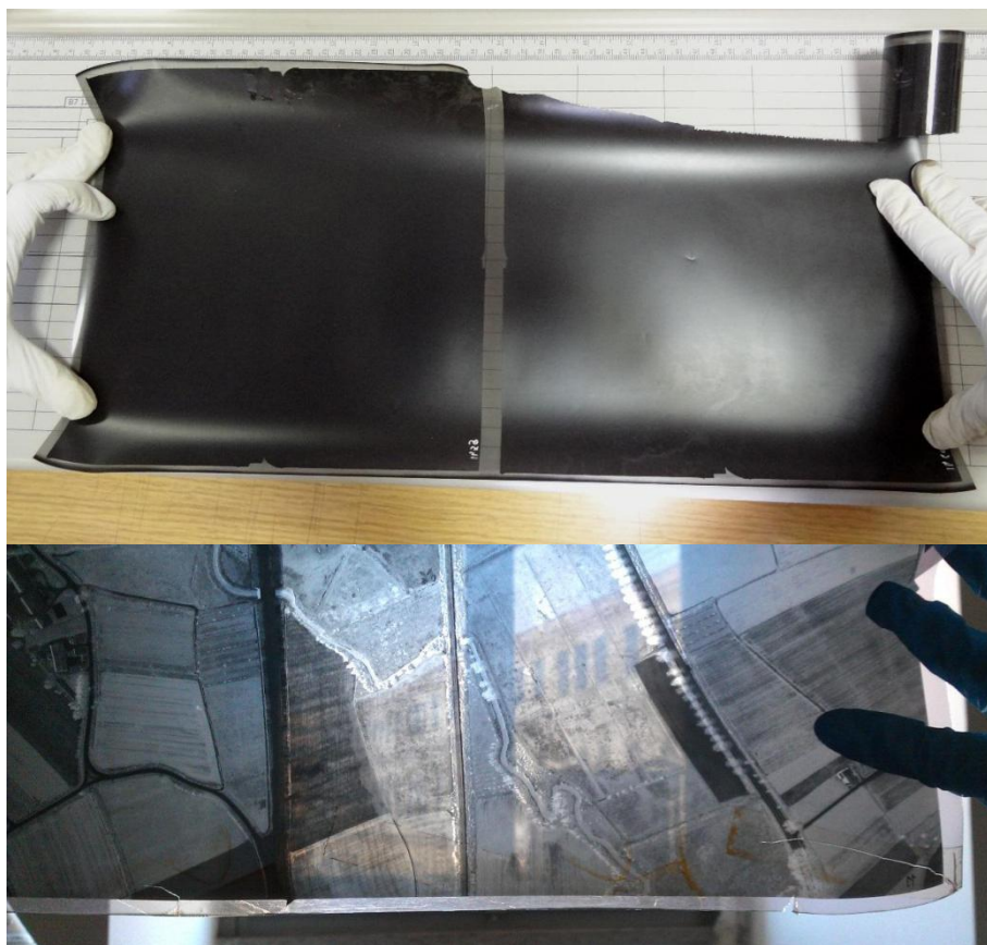
Figg.12-13. AFN, AN, fondo AM. In alto: strappo al margine superiore della pellicola; in basso: strappi al margine, risarciti con nastro adesivo. In corrispondenza degli strappi sono visibili macchie di colore arancione, segno del danno causato dall'adesivo.
