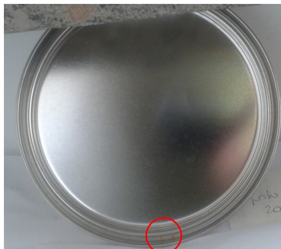
Fig. 8 – il provino 4 (non trattato) dopo due giorni di esposizione in ufficio e nebulizzazione. Evidenziate nel circoletto in rosso, sono visibili piccole tracce di corrosione alla base
