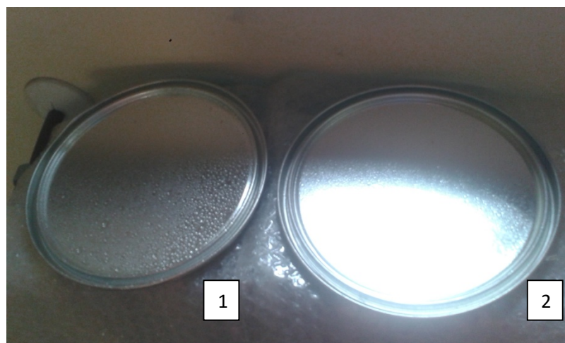
Fig. 5 – i provini 1 e 2 ( non trattato e trattato) appena nebulizzati
