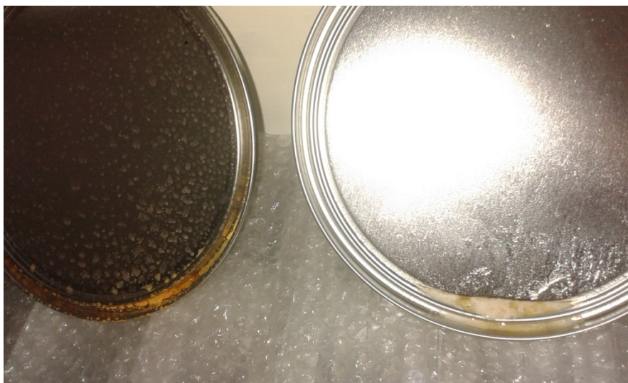
Fig. 7 – i provini 1 e 2 (non trattato e trattato) dopo due giorni di esposizione in archivio e nebulizzazione – particolare della parte di appoggio
